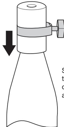
Falls der Durchmesser der Schelle zu klein ist, drehen Sie gegebenenfalls die Stellschraube nach links, um ihn zu vergrößern.
