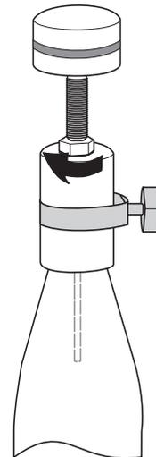
Drehen Sie den Logger nach rechts in den Flaschenadapter, bis die gewünschte Eintauchtiefe erreicht ist.
