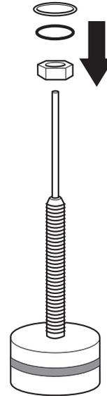
Schrauben Sie die beiliegende M 10 – Mutter auf das Gewinde des Loggers.
