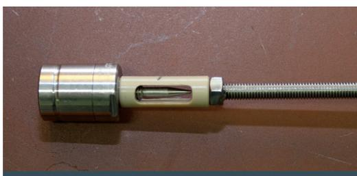
Bevor die Logger zum Einsatz kommen, werden alle Logger über das Softwareprogramm Winlog.pro in einer von der QS vorgegebenen Konfiguration gleichzeitig programmiert. Durch die Festlegung auf insgesamt nur zwei unterschiedliche Konfigurationen kann auch nachträglich die Position jedes einzelnen Loggers im Pasteurdurchlauf in der späteren Auswertung zurückverfolgt werden und braucht nicht einzeln hinzuprogrammiert werden.
